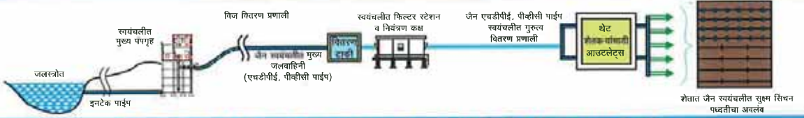
जैन एकात्मिक सुक्ष्म सिंचन योजना; दाब व गुरुत्व (Gravity) नियंत्रित वितरण प्रणाली मॉडेल
